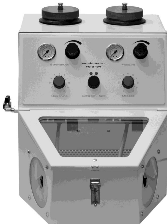
Düsen von Durchmesser 0.4 - 2.7 mm einfach austauschbar
